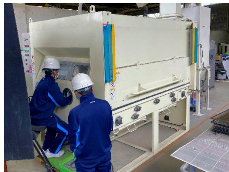
(パネルの表面ガラス剥離装置の操作)
